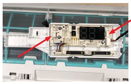
12. Подключите кабель, который идет в комплекте с пультом (17401204A00032 WRC connection cable).
