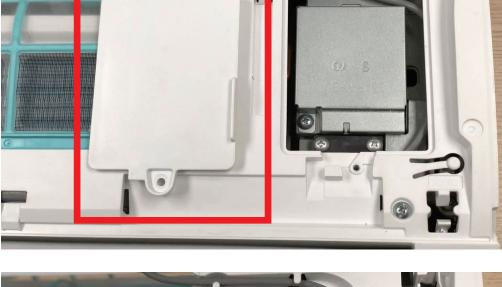
**5.**От дисплея (виден на внутренней стороне верхней панели, фотография из пункта 2.) отходит кабель в изоляции серого цвета, расстыкуйте разъем на этом кабеле под крышкой клеммников.
